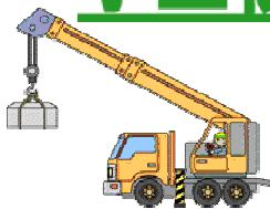
労働安全衛生法の規定により、つり上げ荷重1t以上5t未満の小型移動式クレーンについては、都道府県労働局長に登録する機関が行う技能講習を修了した者でなければ運転できることになっております。
